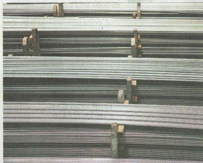
Luščeno jeklo je svetlo jeklo in je namenjeno izdelavi najzahtevnejših izdelkov avtomobilске ter druge industrije, kot so polosovine, zobniki, zobate letve, vzmeti ...
