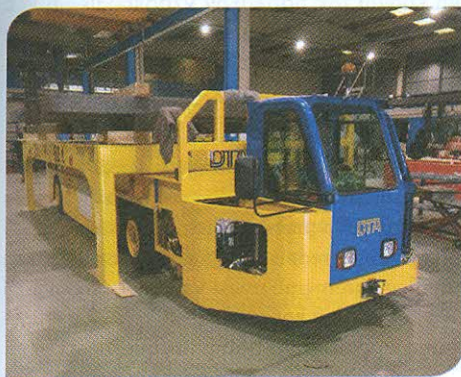
Električno cestno vozilo DTA za prevoz valjancev
